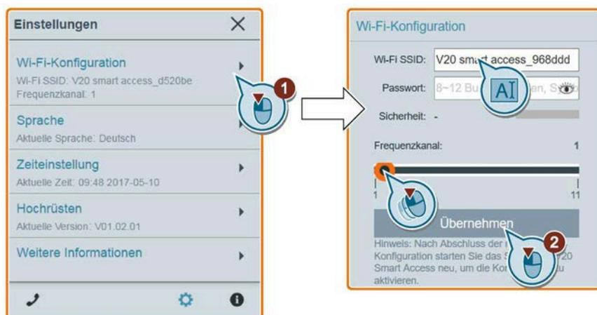
Beachten Sie, dass die neue WLAN-Konfiguration erst nach einem Neustart des SINAMICS V20 Smart Access wirksam wird.
